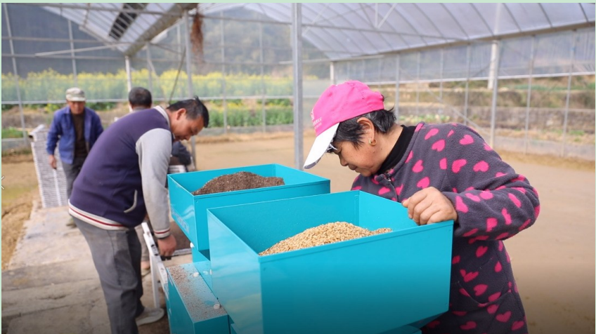
▲在全新的育秧流水线上,铺土、洒水、播种、覆土等道工序一气呵成
